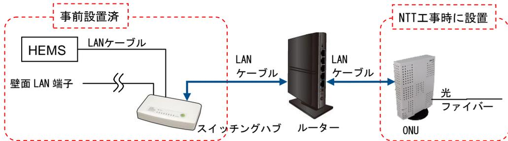
4.2 「ルーターの LAN 端子とスイッチングハブ」、「パソコンの LAN 端子とスイッチングハブ」を LAN ケーブルで接続します。
