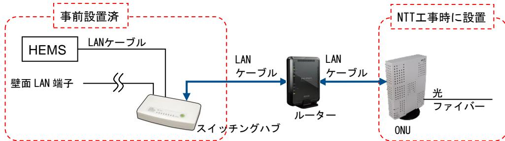
4.2 「ルーターの LAN 端子とスイッチングハブ」、「ルーターのインターネット接続端子と光回線終端装置（ONU）」、「パソコンの LAN 端子とスイッチングハブ」をそれぞれ LAN ケーブルで接続します。
